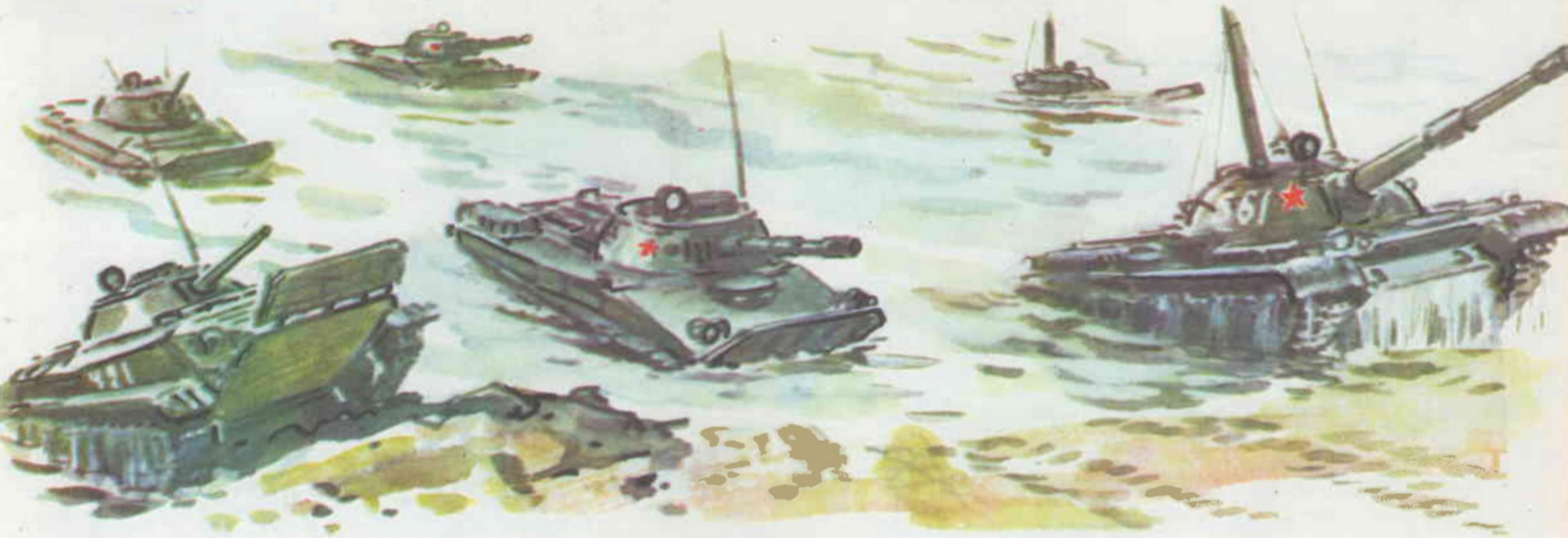
А тяжёлые танки один за другим скрываются под водой. Только специальные воздухопитающие трубы бороздят поверхность реки. Минута, другая — и танки выползают на противоположный берег.
